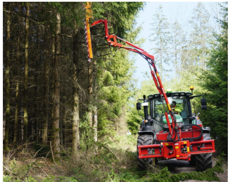
Lichtraum freischneiden: Das Lichtraumfreischneidegerät entfernt Äste, damit der Straßenkörper rascher abtrocknen kann.
